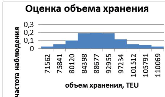
Рис. 8. Плотность распределения объема хранения, полученная методом имитационного моделирования
