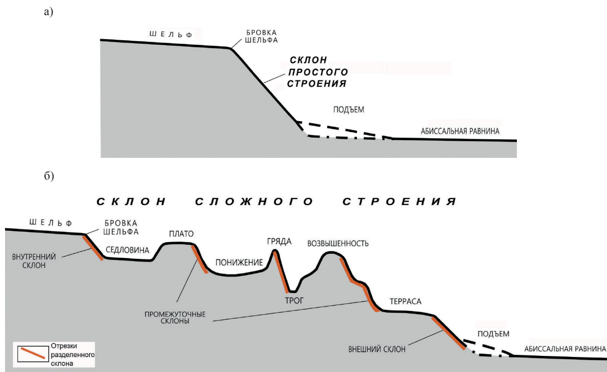
Рис. 3. Схема строения простого (а) и сложного (б) континентальных склонов
