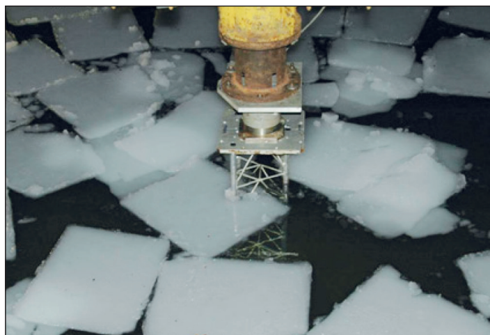
Рис. 4. Взаимодействие опорной колонны СПБУ с битым льдом сплоченностью 90 %
