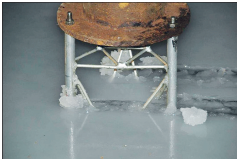
Рис. 5. Взаимодействие опоры СПБУ с ровным льдом (модельные испытания)
