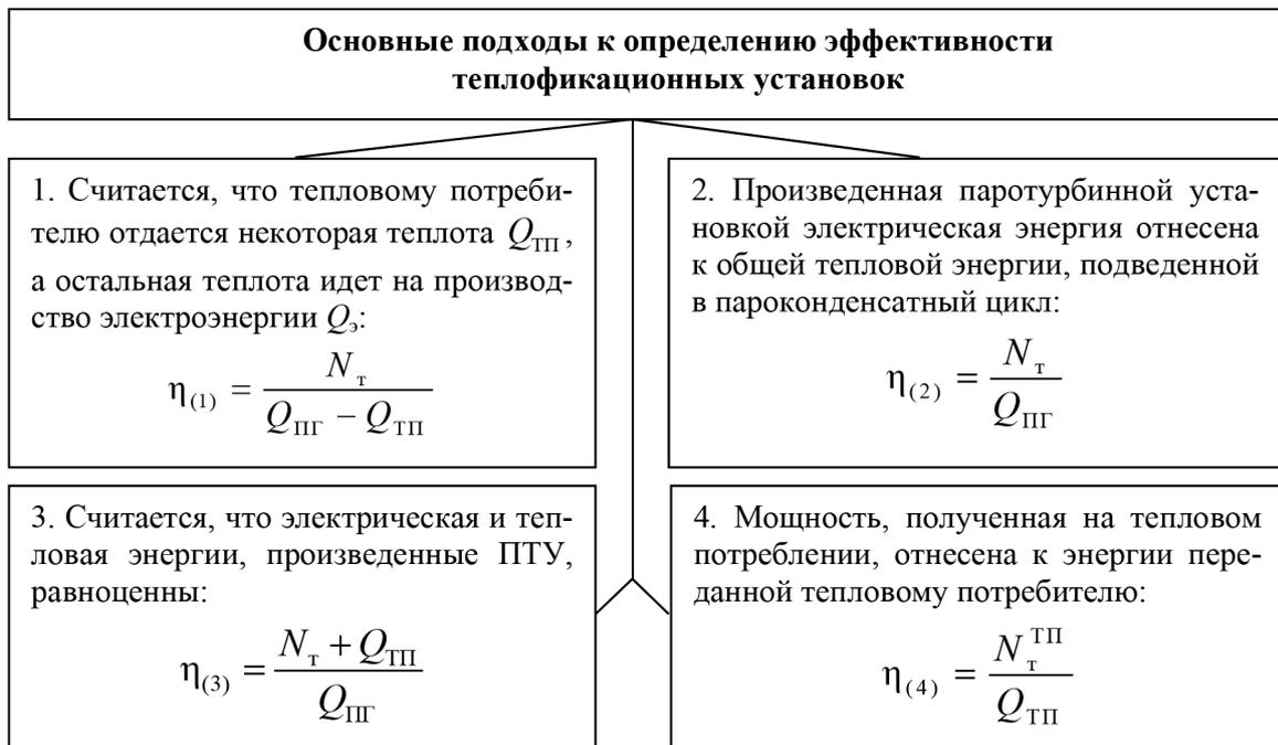
Рис. 4. Основные подходы к определению эффективности теплофикационных установок
