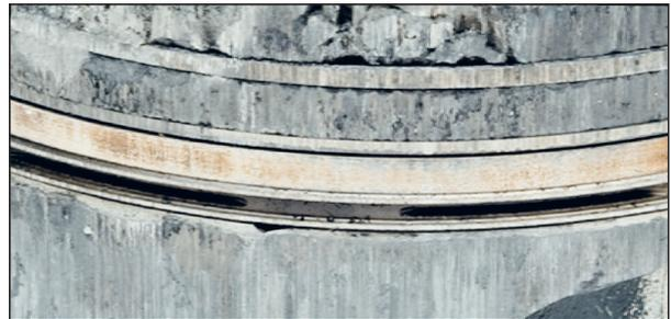
Рис. 3. Оплавленные участки на жаровом поясе поршня (а) и поршневых кольцах (б) дизельного двигателя
