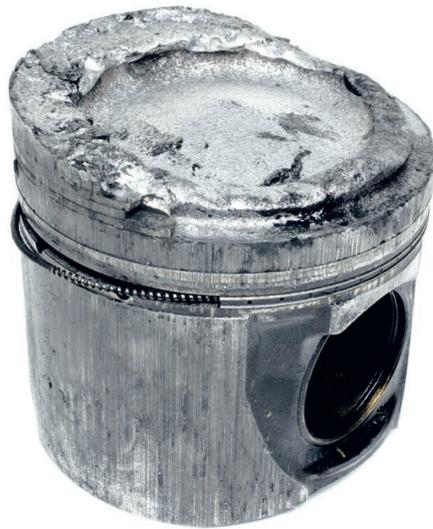
Рис. 2. Расплавленная головка поршня дизельного двигателя
