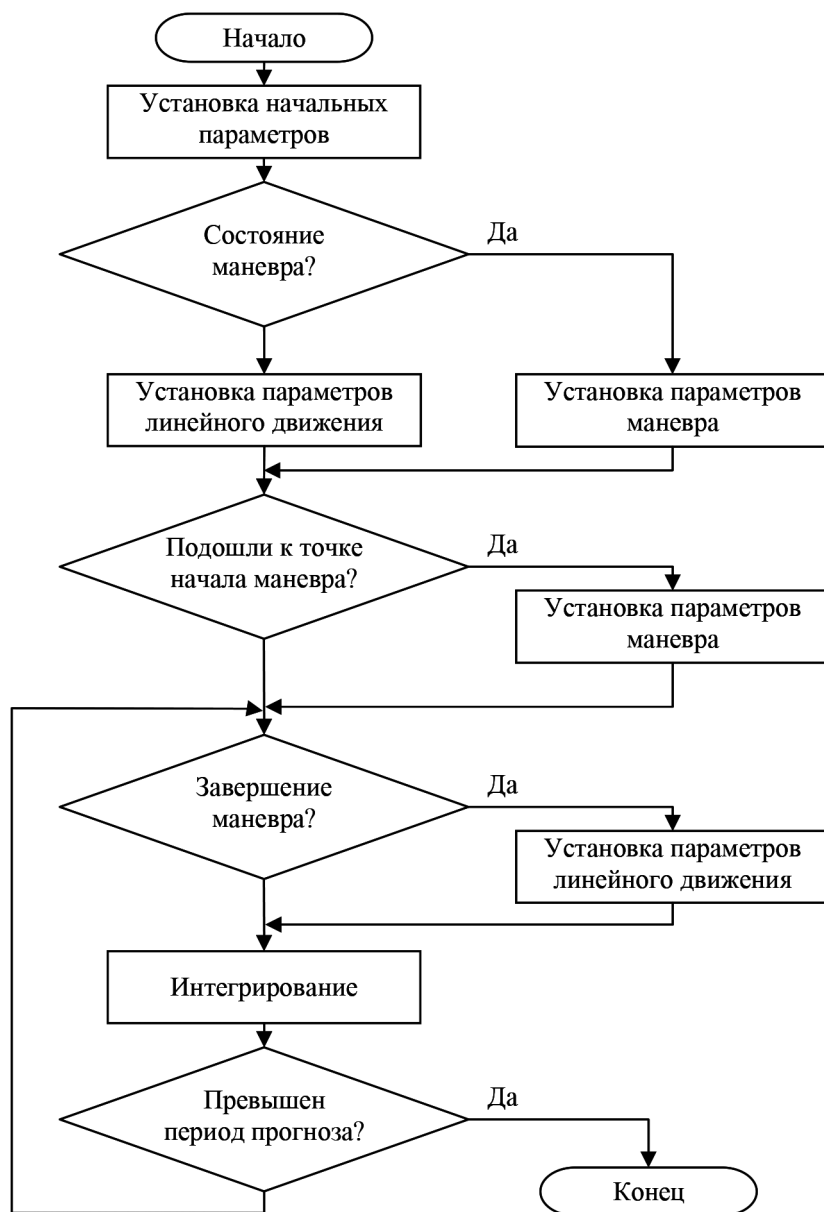
Рис. 1. Схема алгоритма моделирования траектории движения судна
