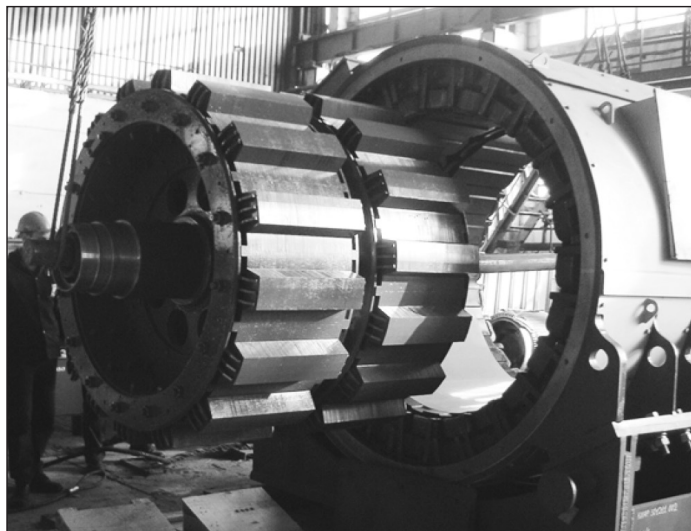
Рис. 9. Сборка вентильно-индукторного двигателя мощностью 2 МВт судна «Виктор Конецкий»
