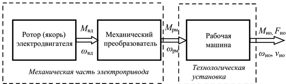
Рис. 2. Структурная схема механической системы электропривода
