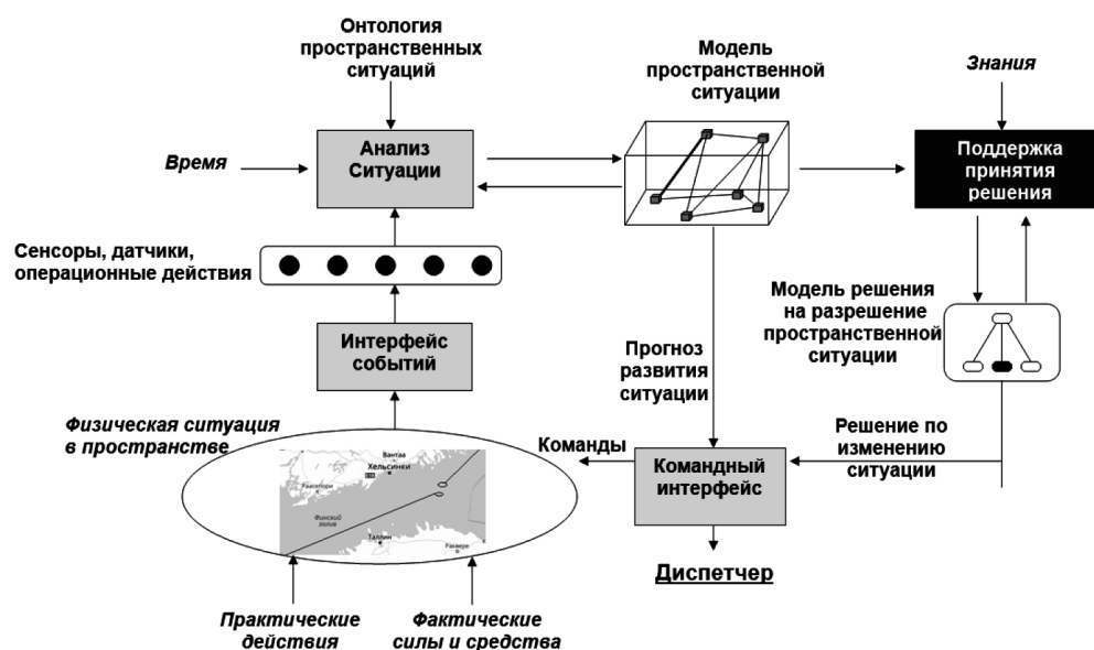
Рис. 3. Логическая структура модели поддержки диспетчеризации геопространственных процессов водного транспорта на основе ситуационного управления
