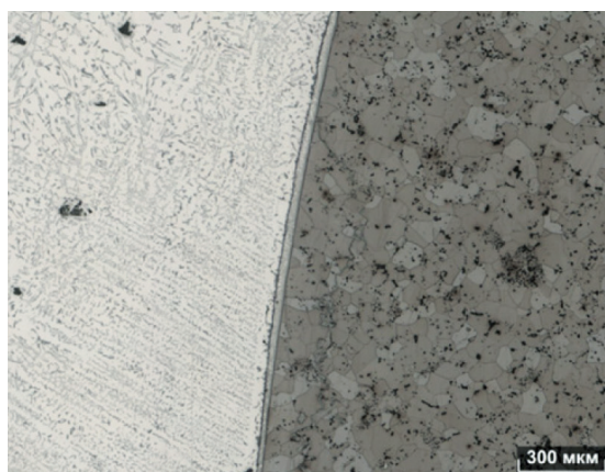
Рис. 2. Микроструктурный анализ экспериментальных образцов: а — № 1 на границе Al-Fe; б — № 2 на границе Al-Fe; в — № 3 на границе Al-Fe (300 мкм); г — № 3 на границе Al-Fe (50 мкм)
