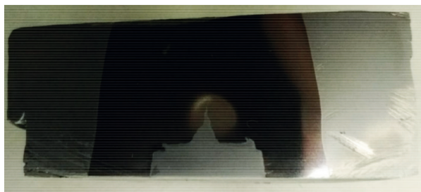
Рис. 1. Экспериментальный образец биметаллического подшипникового узла: а — давление штамповки 50 МПа; б — давление штамповки 90 МПа
