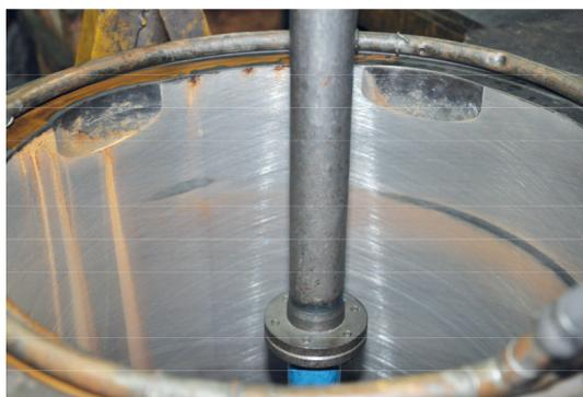
Рис. 1. Рабочая поверхность втулки цилиндра дизеля 6PC2-5L:
