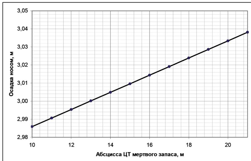
Рис. 2. Процесс изменения значений осадки судна носом при увеличении абсциссы центра тяжести «мертвого запаса»
