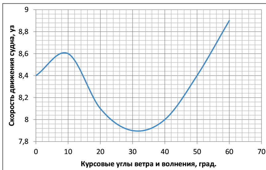
Рис. 7. Изменения скорости танкера в грузу в зависимости от курсового угла ветра и волнения
