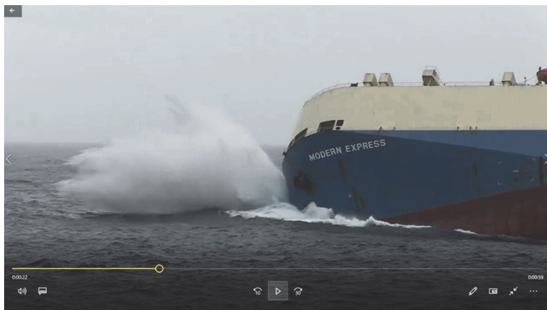
Рис. 4. Удары в развал бортов при буксировке аварийного автомобилевоза на самом малом ходу (источник — личный архив авторов)
