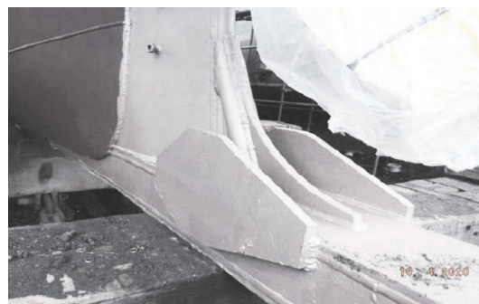
Рис. 9. Фрагменты усиления днища (а) и пятки (б) ахтерштевня судна
