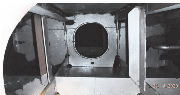
Рис. 9. Фрагменты усиления днища (а) и пятки (б) ахтерштевня судна
