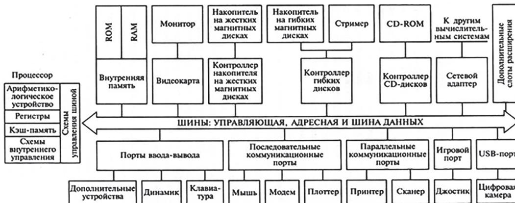
Рис. 2. Функциональная структура компьютера
