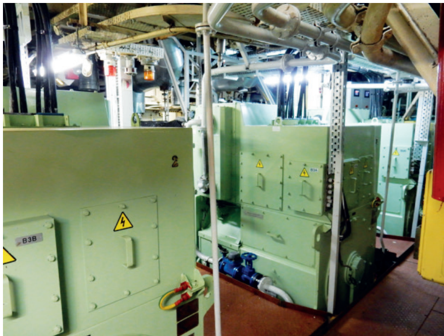
Рис. 3. Главные дизель-генераторы в машинном отделении судна
