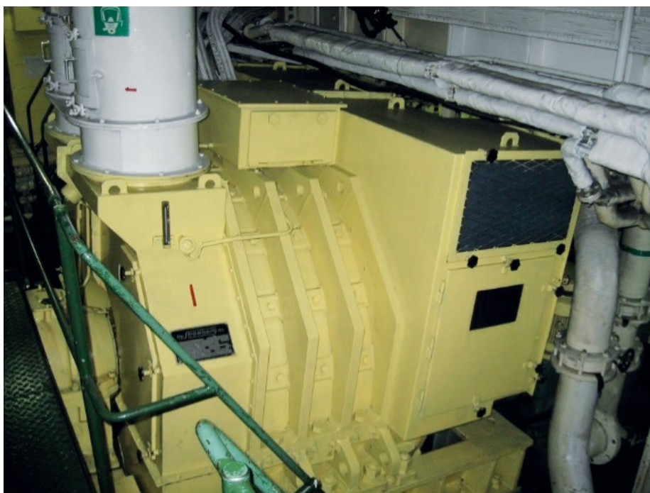
Рис. 4. Главный электродвигатель в моторном отделении судна
