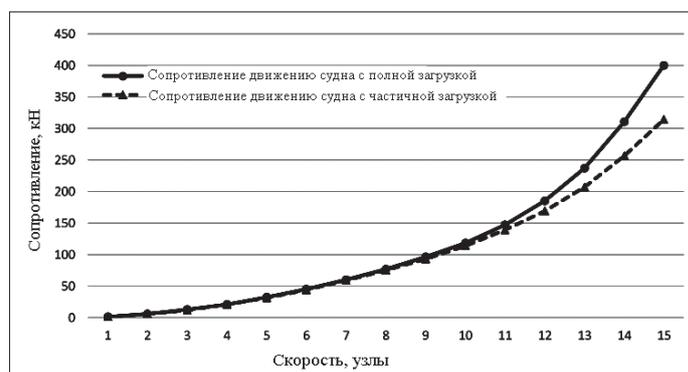
Рис. 4. Значения сопротивления движению судна
