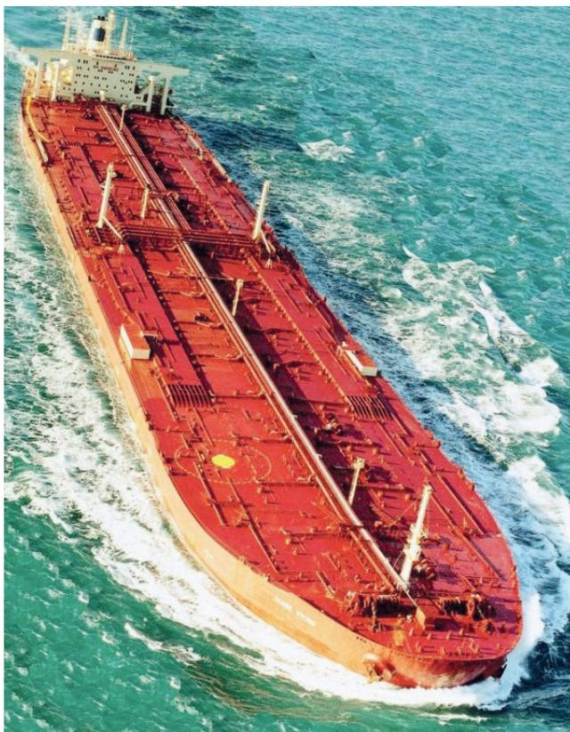
*Рис. 1.* Танкер Knock Nevis дедвейтом 564763 т с паротурбинной энергетической установкой мощностью 37300 кВт (<https://im0-tub-ru.yandex.net/i?id=7f3edc6a20bbaa47788c6250eb9a5d9e&ref=rим&n=33&w=117&h=150>)
