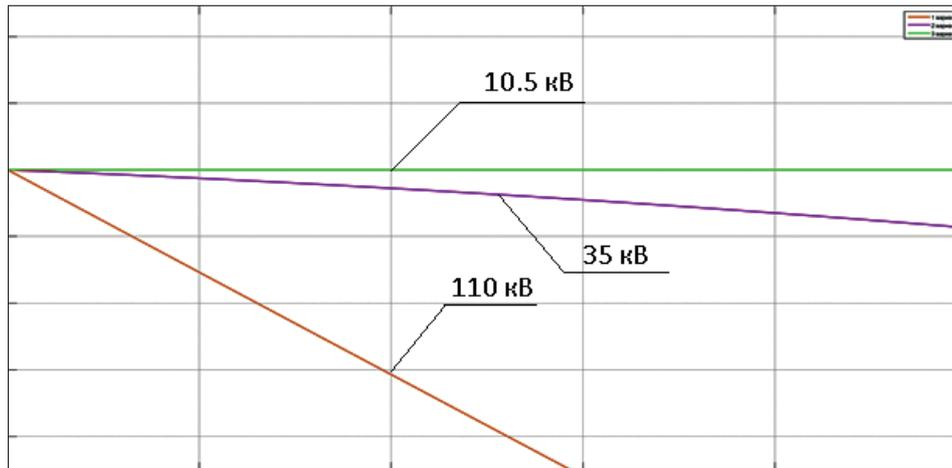
Рис. 7. Вероятность безотказной работы при непрерывной эксплуатации в течение 500 ч для всех вариантов систем передачи
