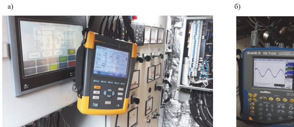
Рис. 8. Электротехнические измерения при проведении испытаний ЕЭЭС с комбинированной пропульсивной установкой:
