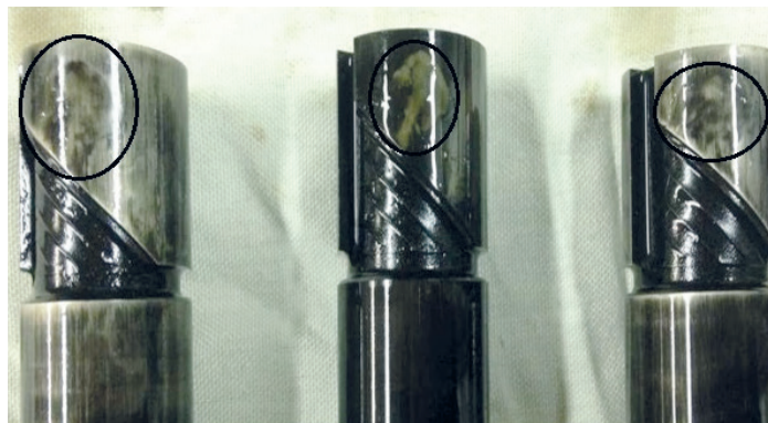
Рис. 4. Состояние плунжерных пар при работе на топливе RMK500 длительностью 2800 мото-ч: а — общий вид плунжерных пар; б — эрозионные пятна на поверхности плунжера
