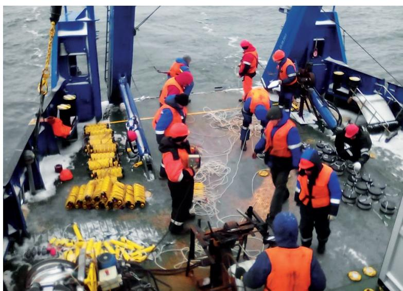
Рис. 6. Работа по постановке станций на палубе судна-раскладчика
