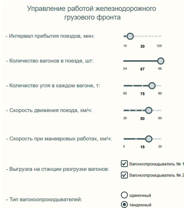
Рис. 10. Интерфейс окна управления имитационной моделью
