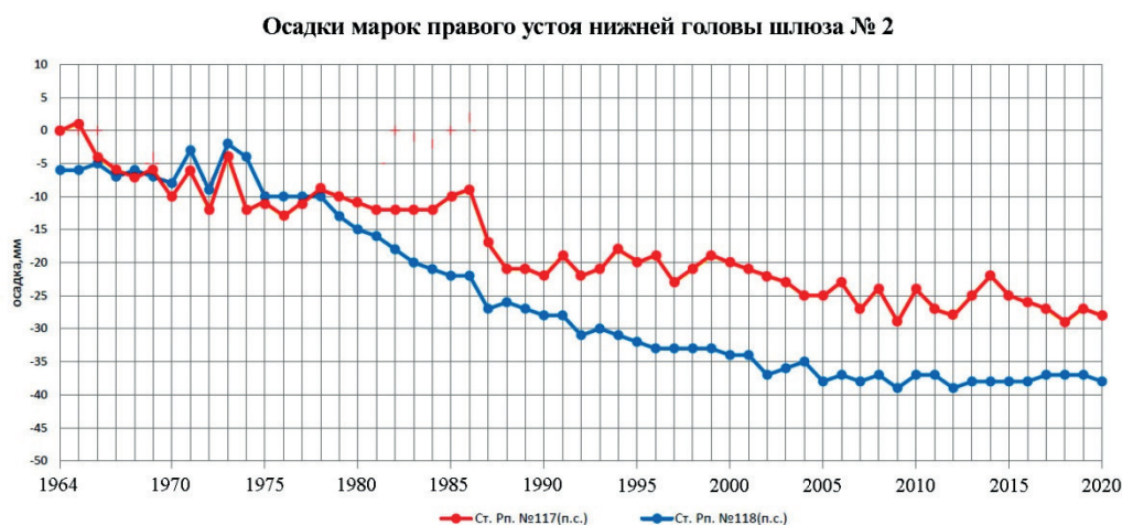
Рис. 6. Осадки марок нижней головы шлюза № 2 ВБВП: а — левого устоя; б — правого устоя
