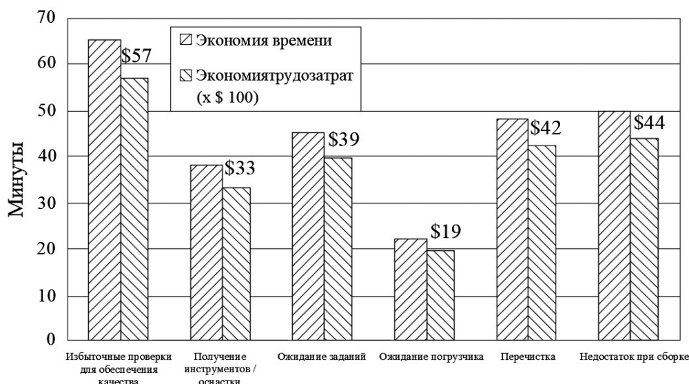
Рис. 5. Результаты оптимизации процесса изготовления двигателей (а), ежемесячная экономия трудозатрат (б)
