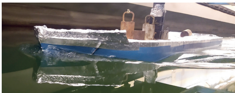
Рис. 2. Фотография модели во время проведения испытаний (посадка на ровный киль, \text{Fn} = 0,23 )
