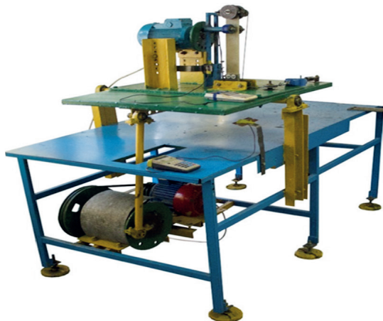
Рис. 3. Установка для испытаний долговечности ПКМ
