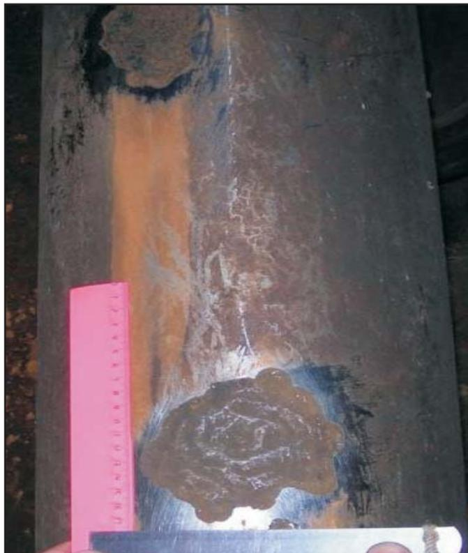
Рис. 2. Коррозионные язвы
