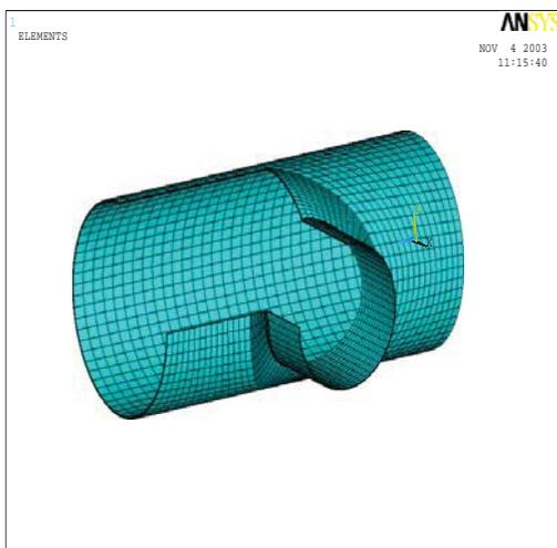
Рис. 5. Разбиение тройникового соединения
