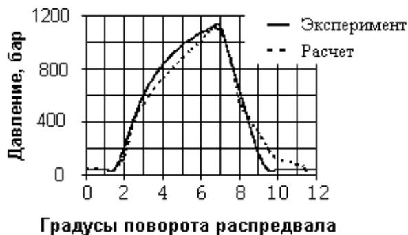
Рис. 3. Характеристика давления впрыскивания
