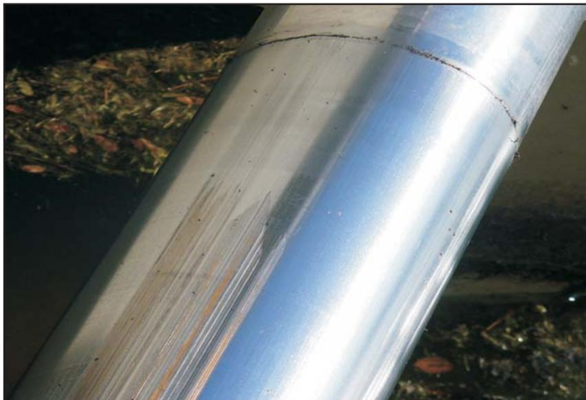
Рис. 1. Риски на хромовом покрытии
