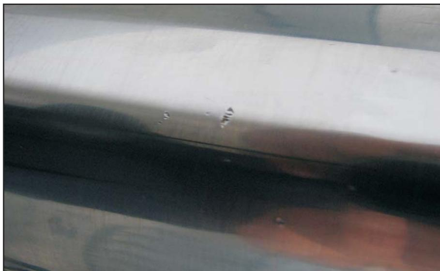
Рис. 3. Поры на поверхности хромового покрытия
