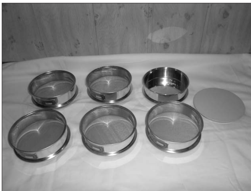
Рис. 1. Набор сит для оценки фракционного состава порошка припоя
