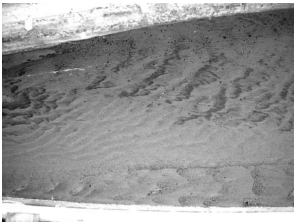
Рис. 5. Движение донных наносов по пойме в донно-грядовой форме
