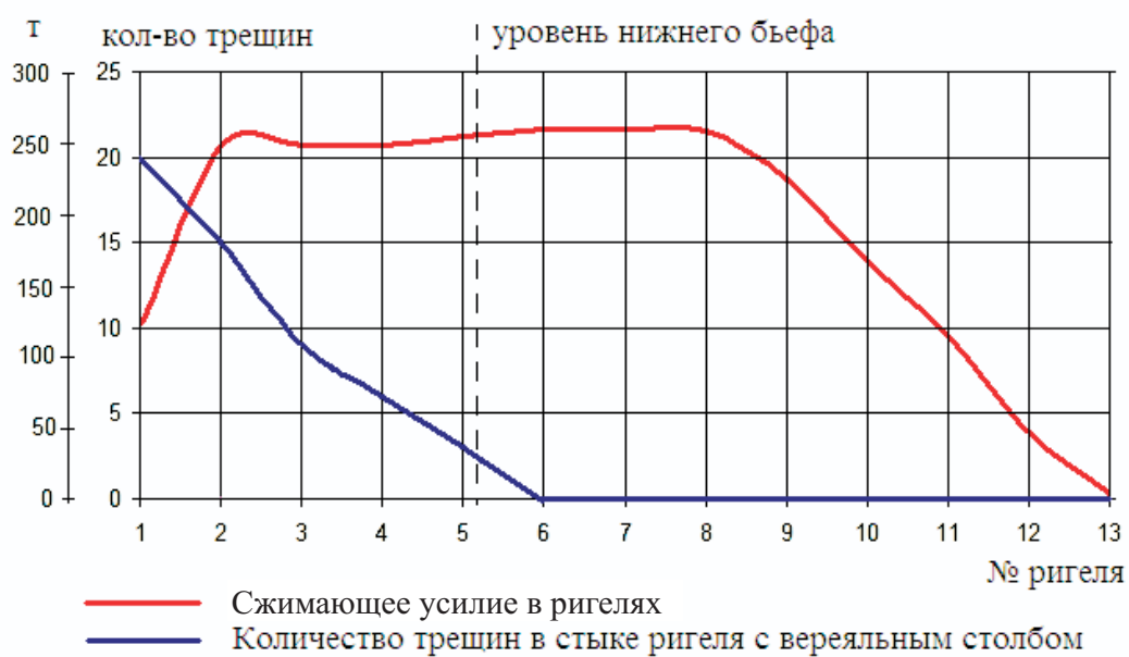
Рис. 4. Распределение числа повреждений и сжимающих усилий по ригелям НДВ
