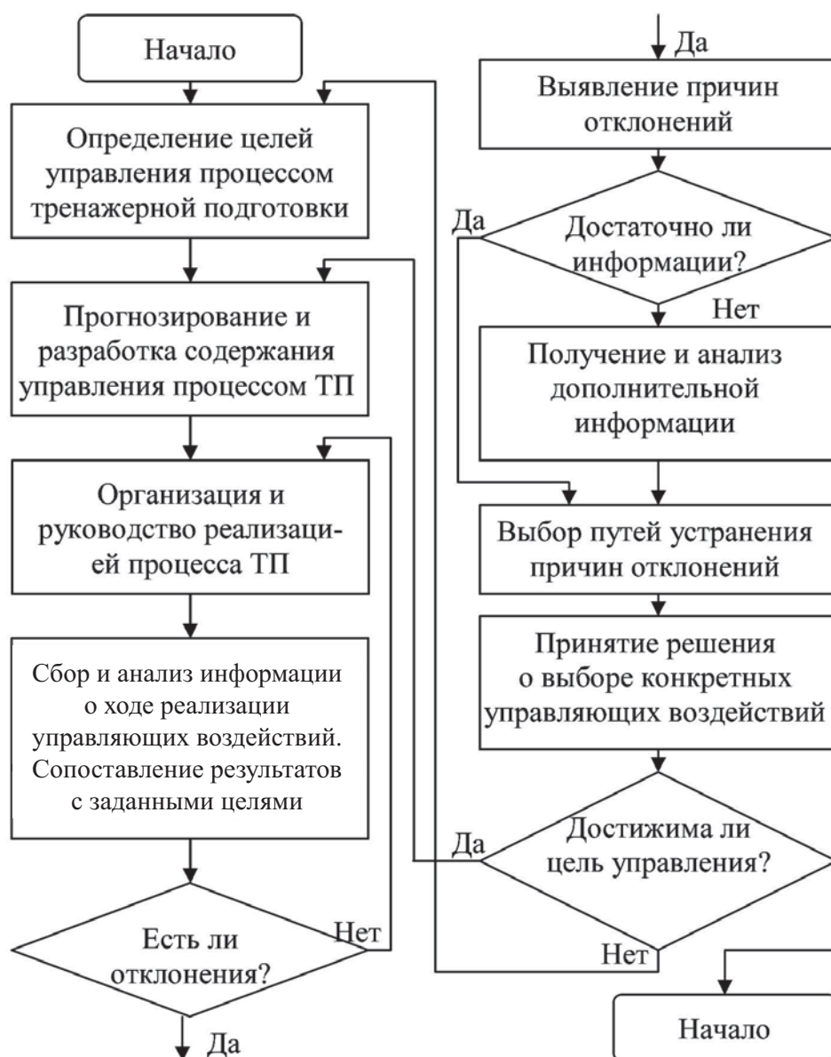
Рис. 2. Этапы функционирования СУКТП в цикле управления
