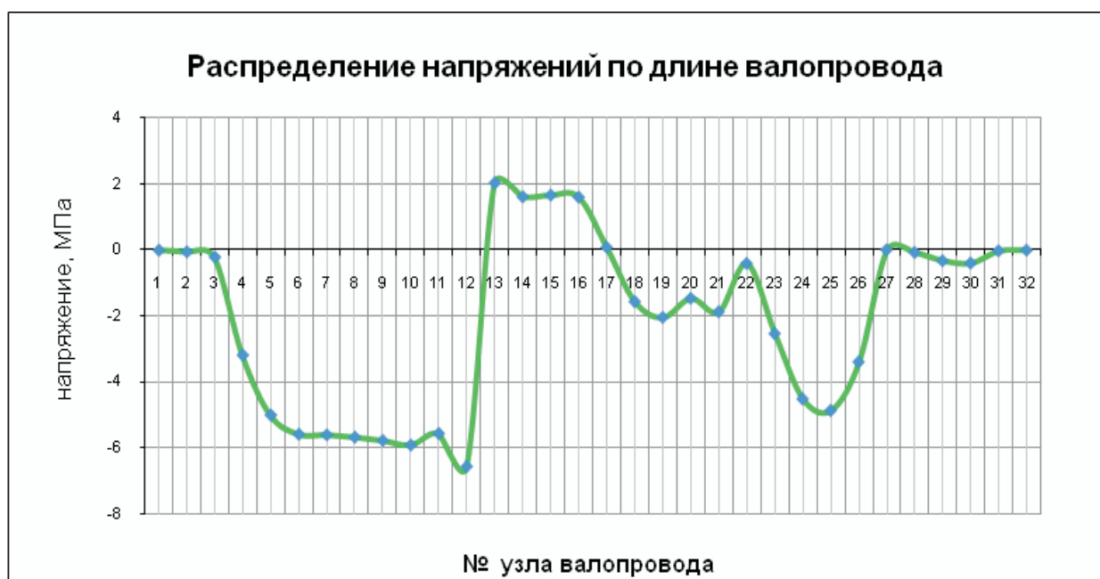
Рис. 7. Распределение напряжений по длине валопровода
