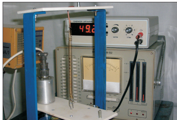
Рис. 1. Экспериментальное оборудование для определения собственных частот пружин
