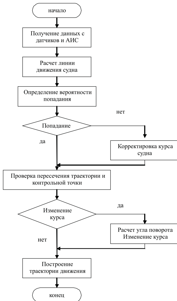
Рис. 7. Алгоритм следования судна по контрольным точкам
