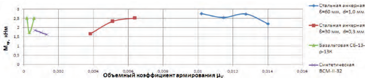
Рис. 3. Графики зависимостей момента трещинообразования M_{тр} от вида фибры и объемного коэффициента дисперсного армирования
