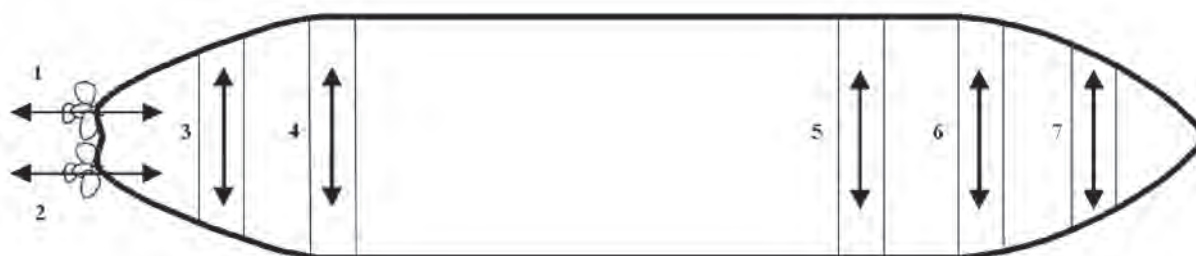
Рис. 2. Схема расположения движителей бурового судна «В. Шашин»
