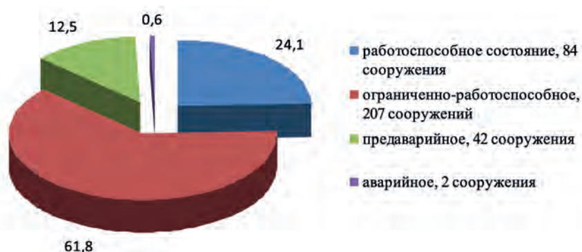
Рис. 6. Структура технического состояния СГТС [7], %
