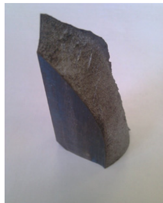
Рис. 2. Фрагмент краевой поломки зуба колеса открытой пары
