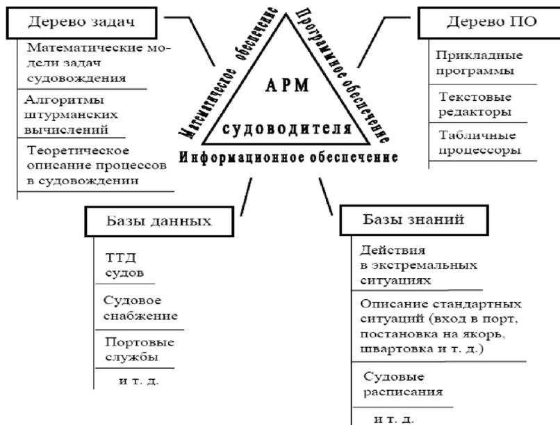
Рис. 1. Основные компоненты автоматизированного рабочего места судоводителя
