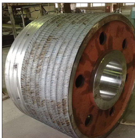
Рис. 8. Канатный барабан (слева) и шкивы, упрочненные плазменной закалкой
