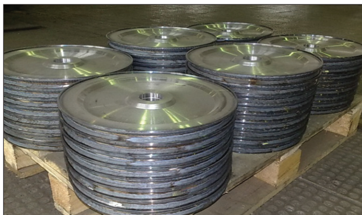
Рис. 8. Канатный барабан (слева) и шкивы, упрочненные плазменной закалкой
