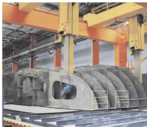
Рис. 1. Использование роботов для изготовления корпусных металлоконструкций:
