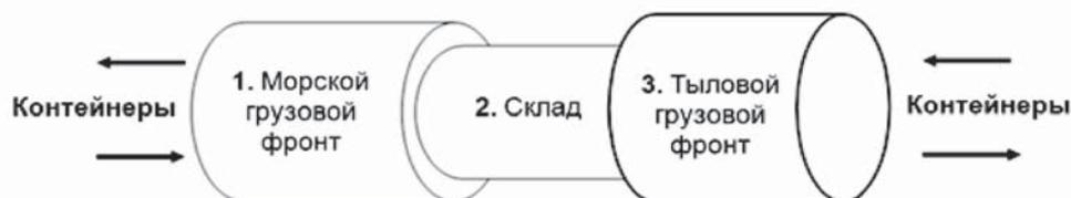
Условная схема технологических элементов портового контейнерного терминала
