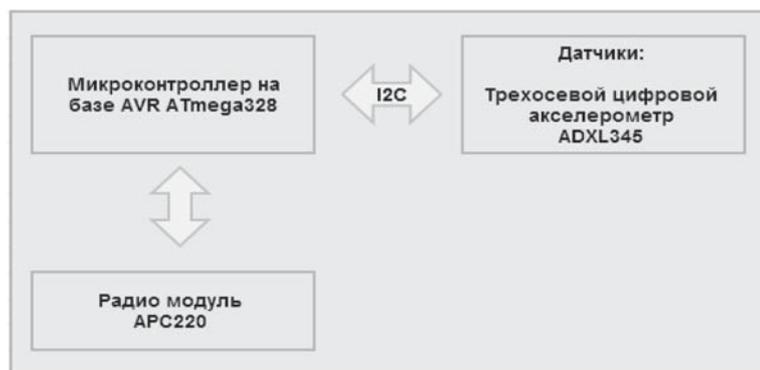
Рис. 1. Структура измерительного блока
