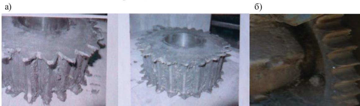
Рис. 6. Характерный износ открытых зубчатых пар:
