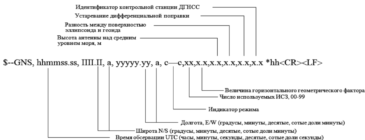
Рис. 5. Предложение интерфейса формата GNS в судовой интегрированной системе навигации
