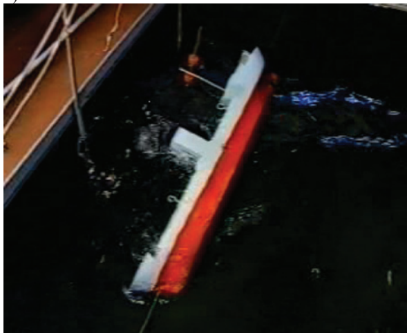
Рис. 1. Модельный эксперимент по определению влияния параметрического резонанса на остойчивость судна: а — судно сохраняет остойчивость; б — крен судна в условиях параметрического резонанса; в — потеря остойчивости судна в условиях параметрического резонанса; г — опрокидывание судна в условиях параметрического резонанса
