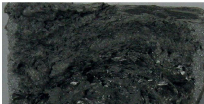
Рис. 6. Пластинчатая структура в центре твэл при интенсивном охлаждении поверхности
