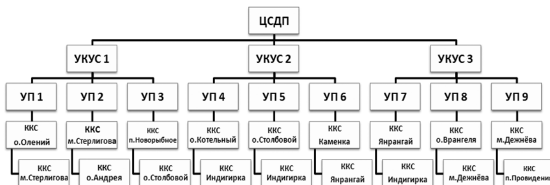
Рис. 3. Схема структуры системы мониторинга дифференциального поля на СМП
