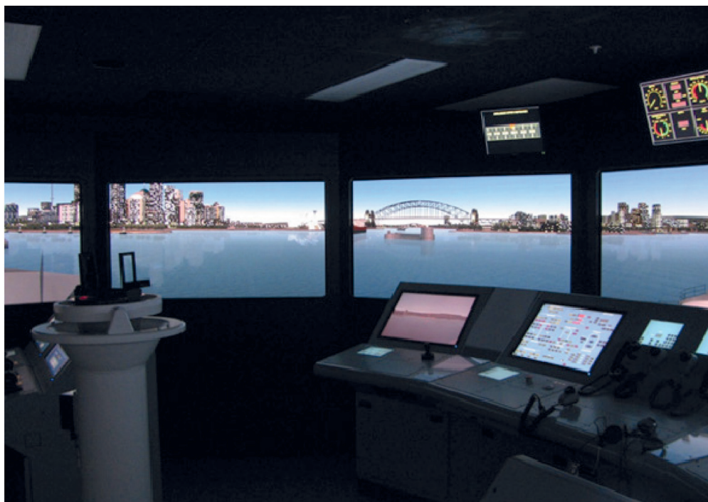
Рис. 6. Виртуальный капитанский мостик грузового корабля по проекту MUNIN
