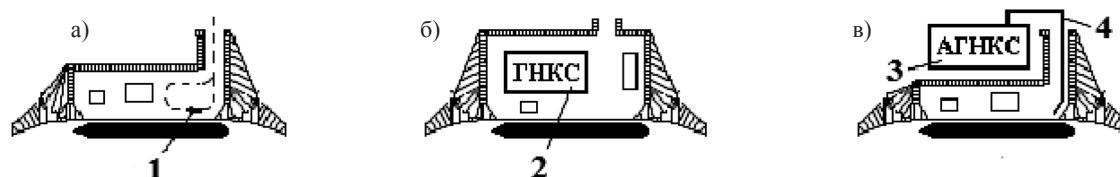
Рис. 2. Схемы заправки судов КПГ давлением 20 МПа со стационарного причала от:
