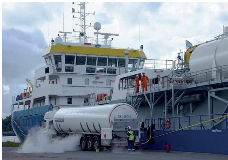
Рис. 2. Заправка судна смешанного плавания сжиженным природным газом в порту Роттердама
