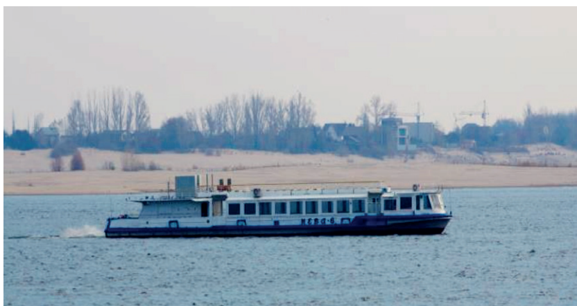
Рис. 7. Судно-газоход «Нева-6» на ходовых испытаниях в районе речного порта г. Волгоград
