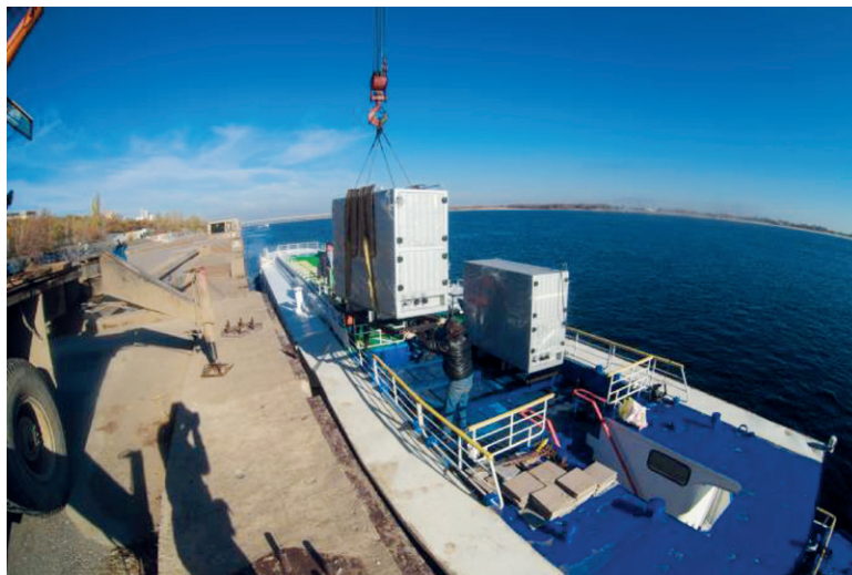
Рис. 5. Погрузка быстросъемных криогенных модулей со сжиженным природным газом СПГ на теплоход «Нева-6»
