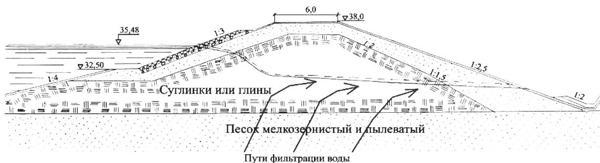
Рис. 4. Поперечный разрез левого крыла дамбы
