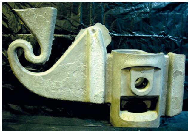
Отливка поршня вместе с литниковой системой
