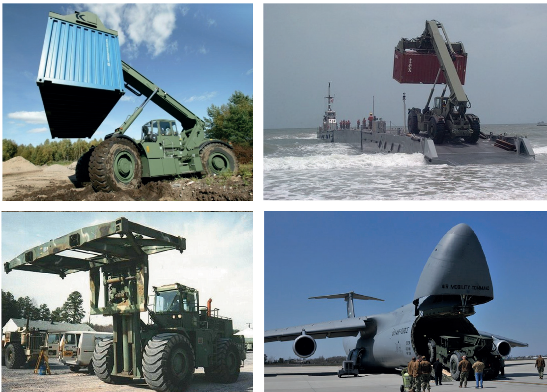
Рис. 8. Контейнерные автопогрузчики для пересеченной местности (Rough Terrain Container Handler, RTCH) армии США
