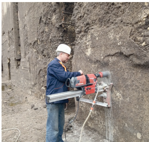
Рис. 2. Рабочие моменты выбуривания кернов бетона из железобетонных конструкций камер шлюза № 31:
