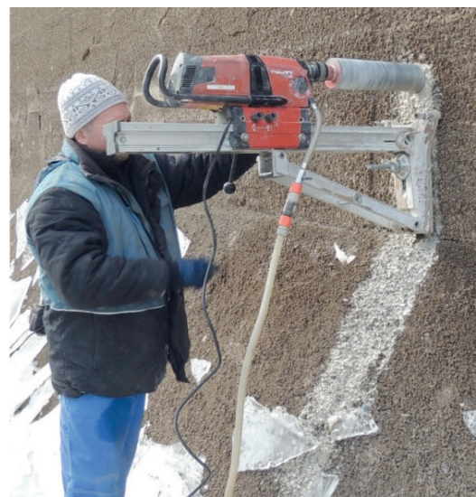
Рис. 2. Рабочие моменты выбуривания кернов бетона из железобетонных конструкций камер шлюза № 31:
