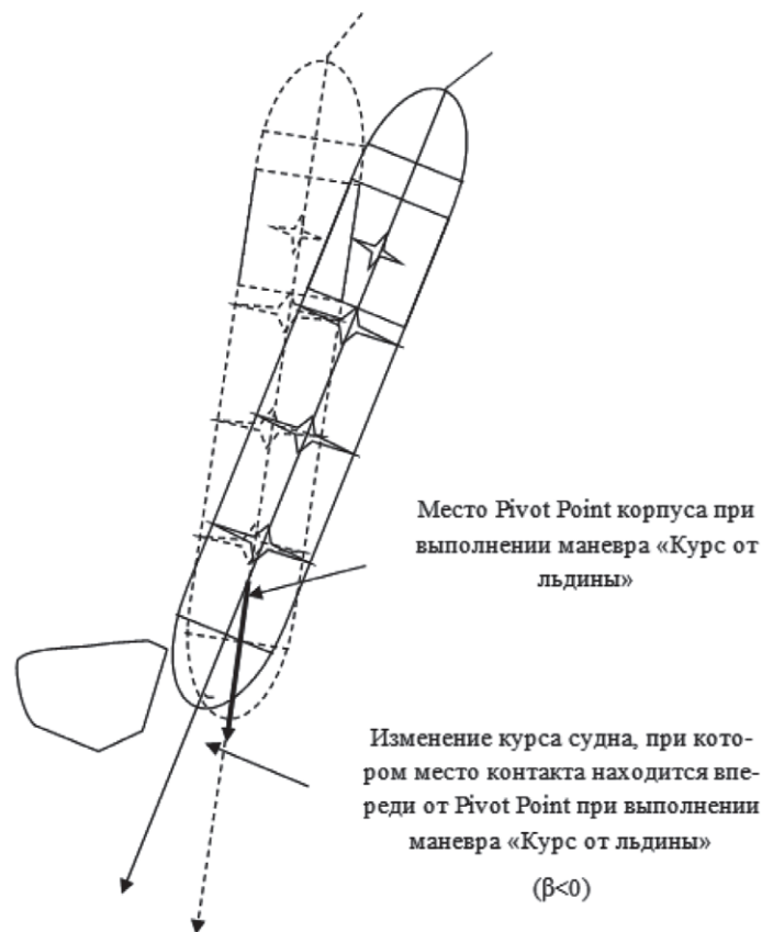
Рис. 5. Изменение курса судна при выполнении маневра «Курс от льдины» для снижения опасности повреждения корпуса
