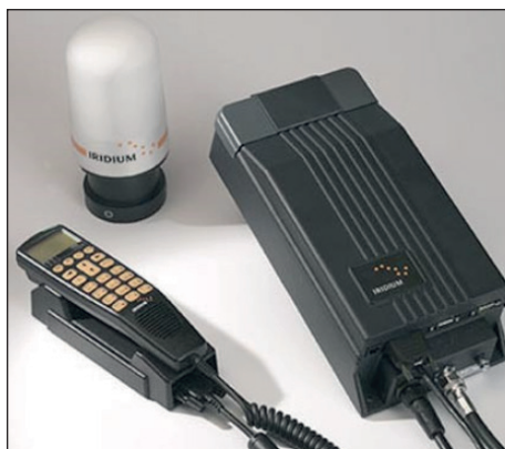
Рис. 6. Внешний вид судового терминала фирма EUROCOM INDUSTRIES
