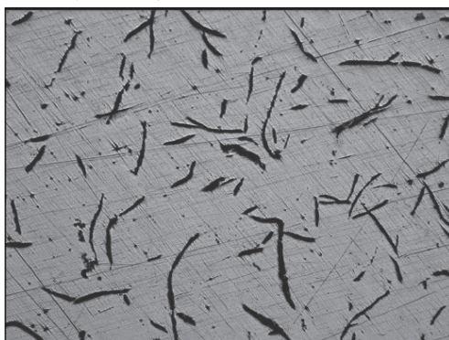
Рис. 1. Форма и распределение графита, \times 50
