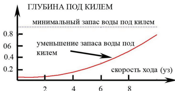
Рис. 2. Изменение запаса воды под килем при увеличении скорости хода: h/T = 1,16
