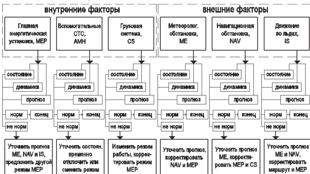
Алгоритм функционирования системы поддержки принятия решений
