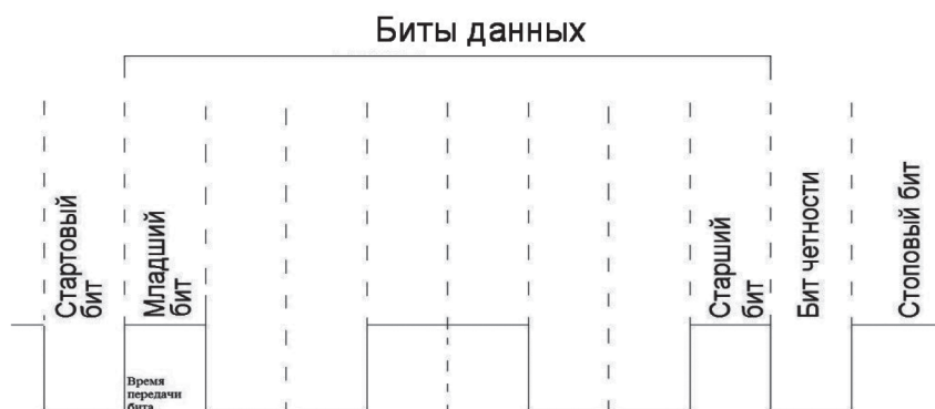
Рис. 4. Схема последовательности передачи данных
