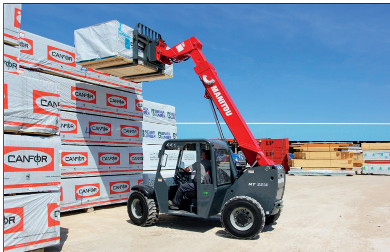
Рис. 1. Самоходный погрузчик с ползунково-кривошипным механизмом
