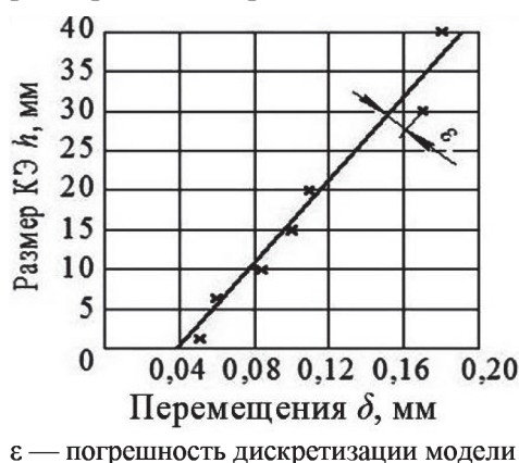
Рис. 6. График зависимости перемещений ( \delta ) от размера КЭ ( h )
