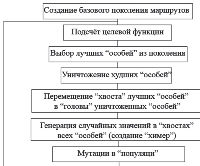
Рис. 9. Общий алгоритм работы модели на AnyLogic 6
