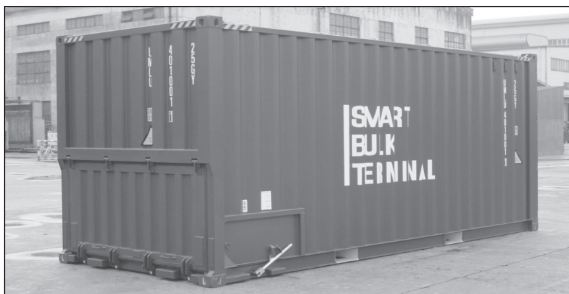
Рис. 1. Специализированный насыпной контейнер для складирования и перегрузки навалочных грузов
