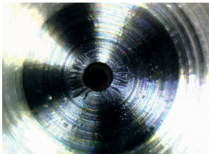
Рис. 5. Характерный вид износа седла клапана форсунки (микросъемка)
