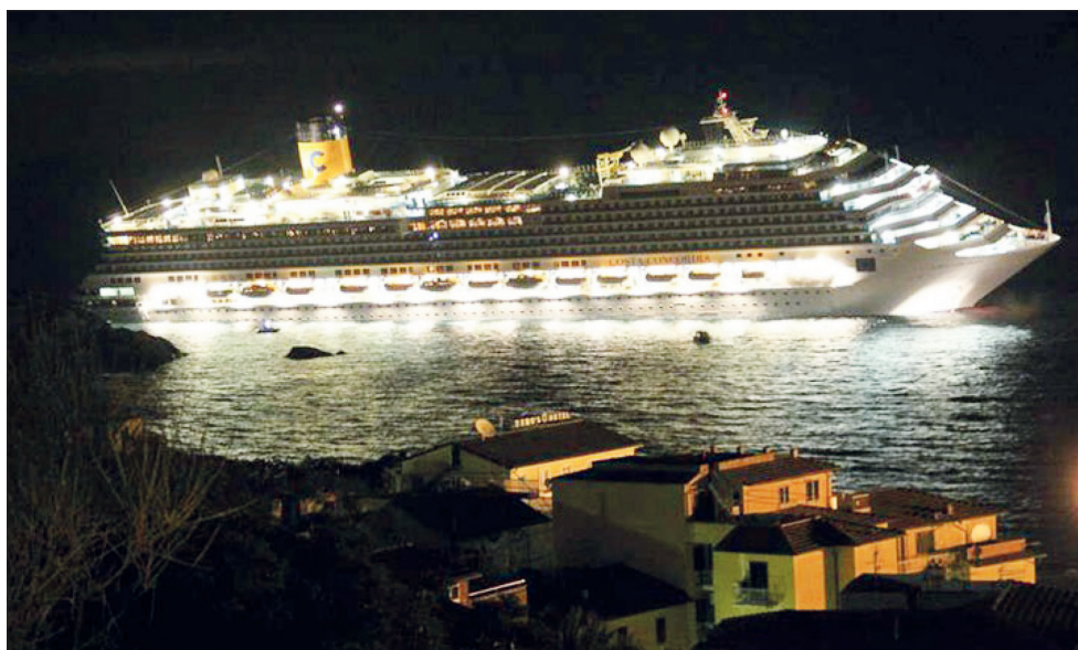
Рис. 1. Лайнер «Costa Concordia» с креном 22° на правый борт перед опрокидыванием (спуск спасательных шлюпок еще не начат)
