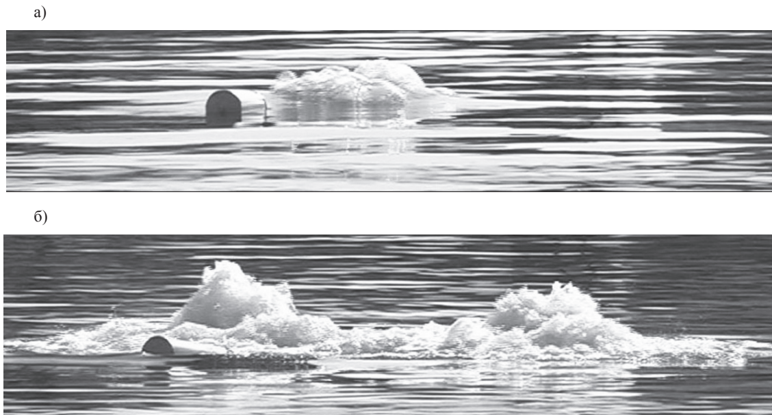
Рис. 8. Процесс продувки натуральных водозаборников: а — продувка одного водозаборника; б — продувка двух водозаборников
