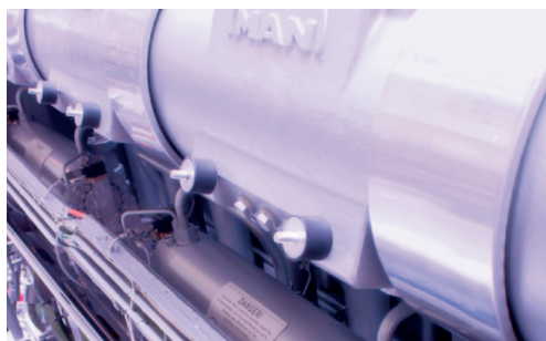
Рис. 14. Система Common Rail на двигателе MAN V32/44CR
