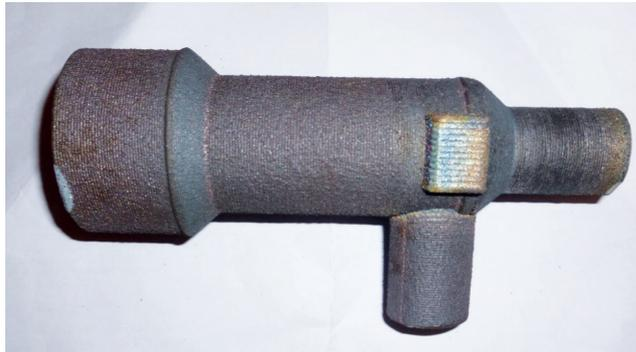
Рис. 3. Заготовка корпуса клапана запорного, сформированная методом ПЛВ
